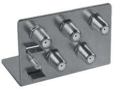
Diese Erdungswinkel verfügen über F-Doppelbuchsen CFA 26-02. An diesen Buchsen werden die Koaxialleitungen angeschlossen. Die QEW x-50 eignen sich insbesondere dann, wenn kompakte, platzsparende Lösungen gesucht werden.
