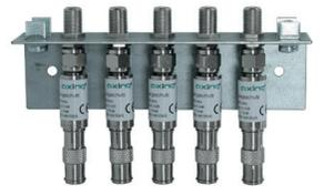
Am Eingang eines Multischalters ist oftmals ein Überspannungsschutz nötig. Die Erdungswinkel QEW x-10/-20/-06 verfügen pro Anschluss über einen Überspannungsschutz SZU 6-02. Auch diese QEW können direkt auf die AXING Multischalter aufgesteckt werden.
